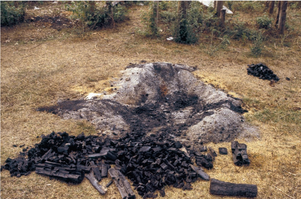
10 Produção de carvão numa pequena fossa, em Loei (norte da Tailândia). Eliminação dos restos de madeira não carbonizados. Fotografia Weisgerber 1985.
